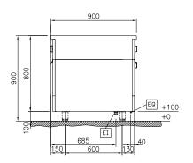
Electrical inlet (power) Equipotential screw
